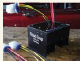
Boîtier électronique opérant ventilateur de radiateur (12v) ou direction assistée (12v) pour voiture 6 volts Exclusif à Fitzback Garage
